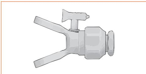
**Положение сопла при очистке («стрелка» направлена в сторону маляра)**
