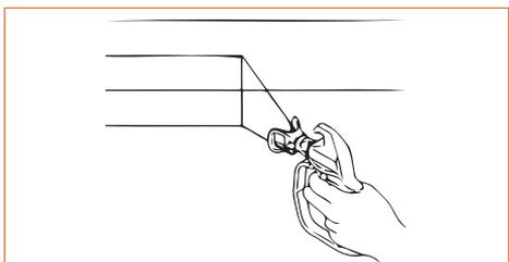
Край распыленной струи должен быть не слишком четким, а размытым, чтобы облегчить наложение следующего слоя покрытия.
