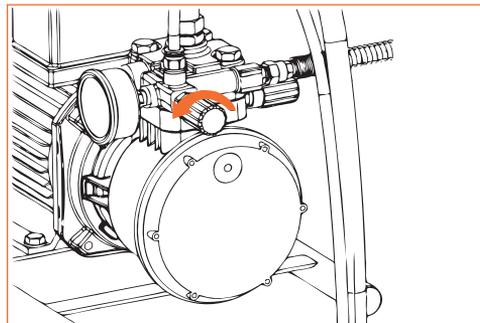
6. Убедитесь, что регулятор давления установлен на минимальное значение (выкручен против часовой стрелки).
