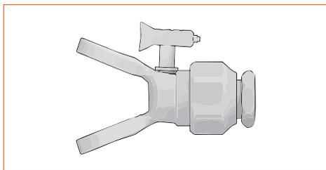
4. Прижмите распылитель к заземленной металлической емкости с жидкостью для промывки. Снимите курок распылителя с предохранителя и нажмите. Из шланга высокого давления выйдет жидкость.
