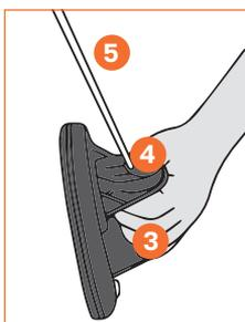
Внутри ручки (3) находится клапан. с помощью специальной проволоки из ремонтного набора (5) выньте стопорное кольцо, а затем клапан (6).
