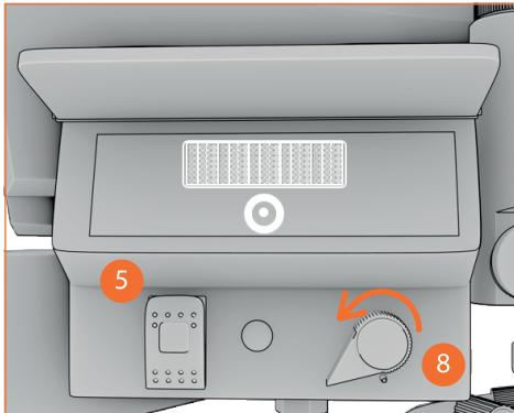
2. Переведите выключатель «5» в положение «I» Включено. Для включения электродвигателя.
