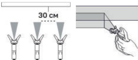
В зависимости от материала улучшение качества покрытия может достигаться применением сопел меньших размеров
