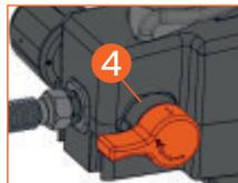
5. Поверните сопло в положение «очистка», направьте в емкость для отходов, снимите курок с предохранителя и нажмите на курок.
