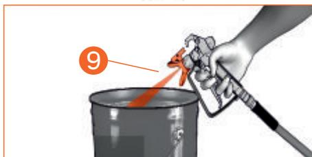
10. Поверните дренажный кран в положение «распыление» и выкачайте воду из бункера, затем отключите аппарат.
