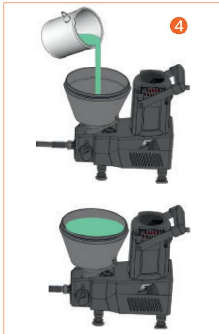
**ПРИМЕЧАНИЕ:** Во время распыления, заглушка на крышке бункера должна быть открыта, чтобы избежать образования воздушной пробки.
