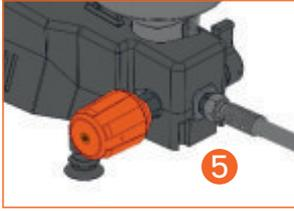
6. Когда распылитель начнет работать, пузырьки воздуха удалятся из системы. Дайте жидкости циркулировать через дренажную трубку в бункере, в течение 30 секунд.
