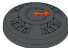
5. Включите электродвигатель и поверните регулятор давления по часовой стрелке.
