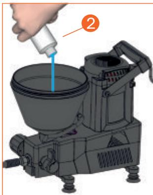
3. Поверните дренажный кран в положение «сброс» и включите аппарат. Некоторое количество масла выйдет из штуцера подсоединения окрасочного шланга (предварительно накройте ветошью штуцер). Затем выключите аппарат.
