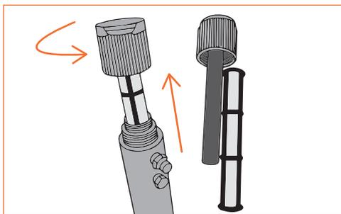
8. Очистите фильтр в ручке пистолета. Отсоедините защитную душевую, выньте фильтр.
