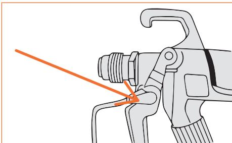
4. Заполните гайку уплотнения горловины составом для уплотнений, чтобы предовратить преждевременный износ уплотнения. Заполнение горловины насоса смазкой производится через прорези в защитном кожухе (4).
