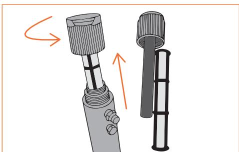
**8.** Очистите фильтр в ручке пистолета. Отсоедините защитную душку, выньте фильтр.
