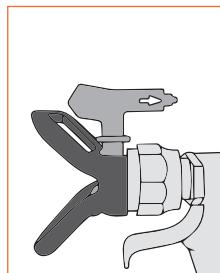
**4.** Прижмите распылитель к заземленной металлической емкости с жидкостью для промывки. Снимите курок распылителя с предохранителя и нажмите. Из шланга высокого давления выйдет жидкость.
