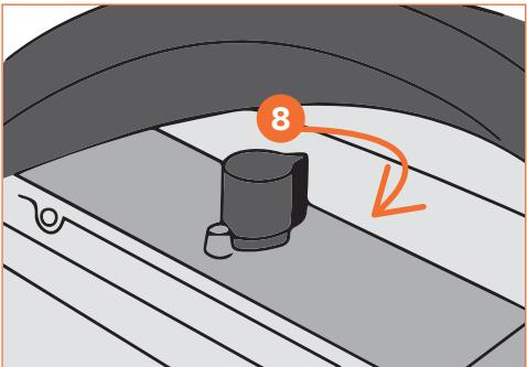
4. Поверните кран заливки (6) вверх для закрытия дренажного клапана.
